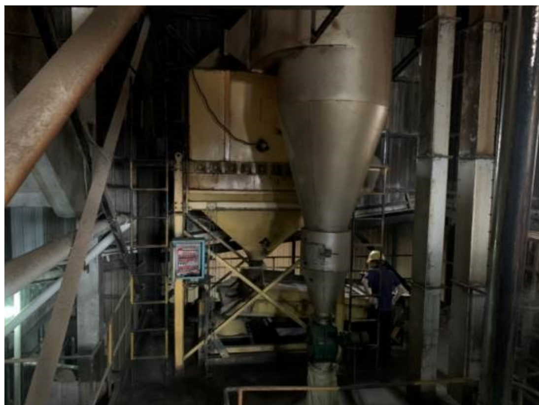
破碎机及配套的布袋除尘器
