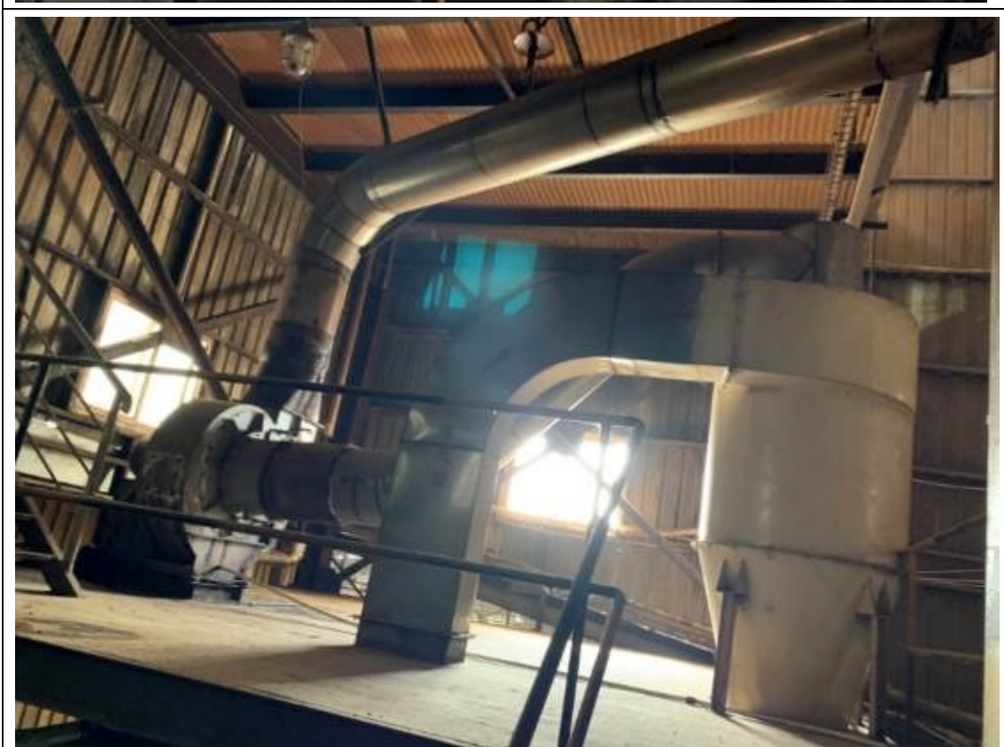
配套的脉冲除尘器
